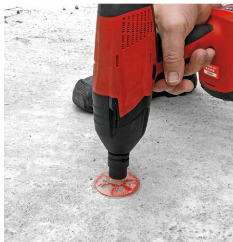
Csavarbehajtóval, racsnis- vagy villáskulccsal (SW 17) kicsavarozható.
