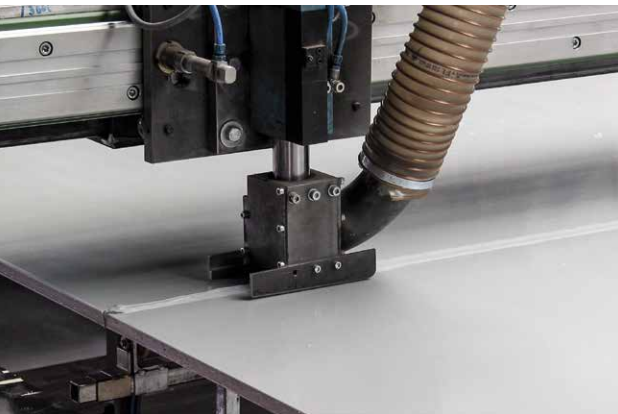
Peaux de 20 mm aboutées par soudage pour obtenir une surface sans joints. Le soudage des angles se fait comme pour l'acier, la soudure est résistante et fiable.
