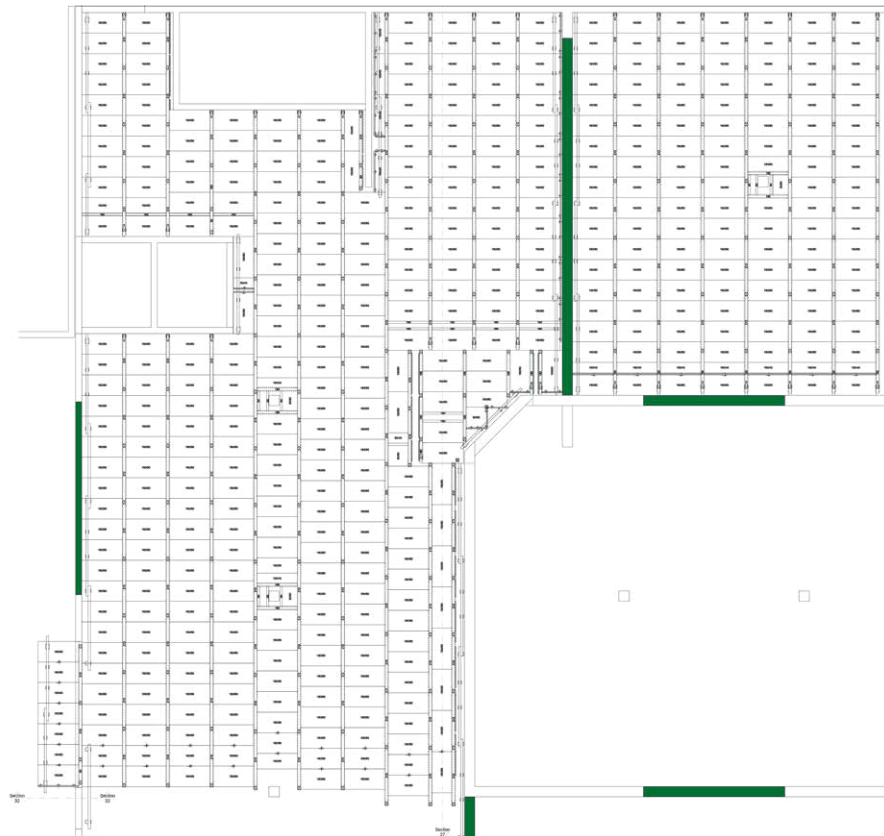
Le coffrage des dalles a été planifié à l'aide d'outils numériques.
