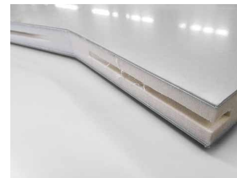
Eingefräst und stumpf gestoßen, mit Lamello-Verbindern und ohne Schweißnaht verbunden.
