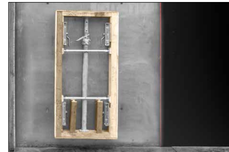
Aussparungen Anbringung von Aussparungen und Dreikantleisten durch Magnete
